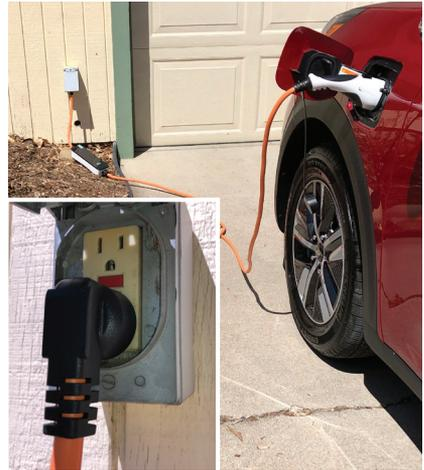
Ce câble de niveau 1 peut être branché sur une prise électrique domestique dédiée de 110 volts.
