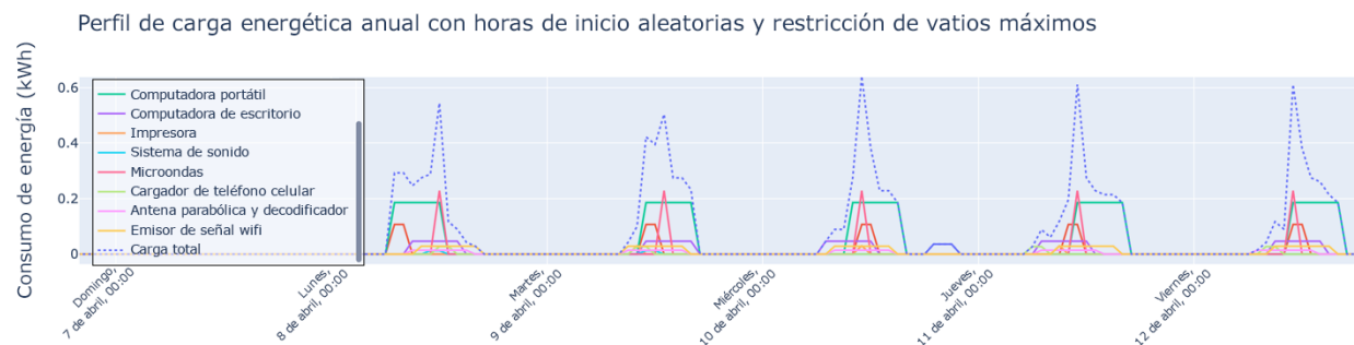
Gráfico 2. Ejemplo de modelado de variación de carga para una escuela con 7 a 10 aulas
