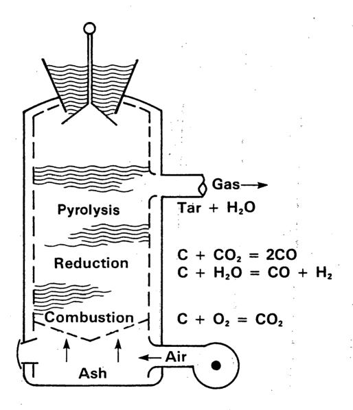
Figure 4. SCHEMATIC DIAGRAM OF UPDRAFT GASIFIER
