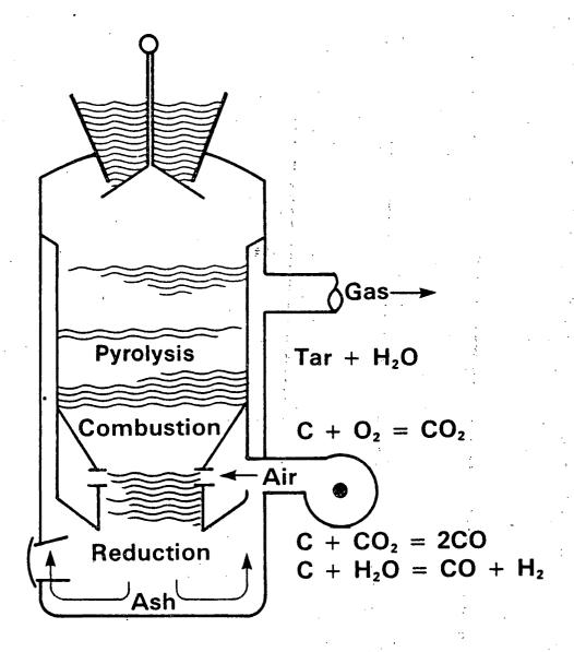
Figure 5. SCHEMATIC DIAGRAM OF DOWNDRAFT GASIFIER
